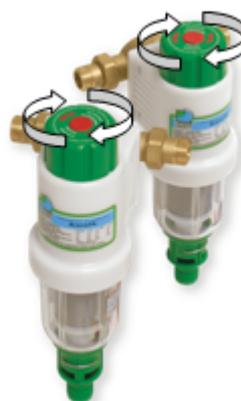
BravoFIL è dotato di piastra posteriore d'attacco ruotabile di 360° (a scatti di 90°) in ottone resistente alle sollecitazioni meccaniche e alle tensioni che sono in grado di portare alla rottura delle testate in plastica. La piastra
